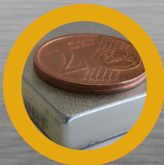
Stahlblech, leichter Radius, ca. 0,2 mm
